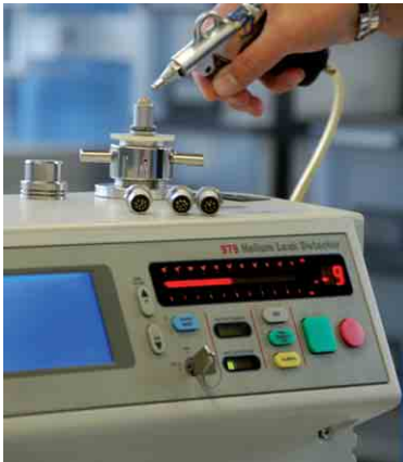
Vacuumtest with leakdetector Vakuumtest mit Leakdetektor
